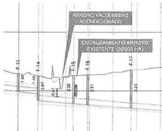
Ilustración 3. Perfil longitudinal. Emisario Fecales
