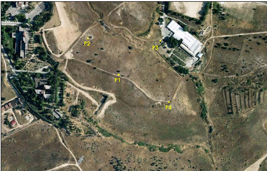
Imagen 4. Localización de los puntos de medida para la evaluación sonora del Club de tiro "Cantoblanco".
