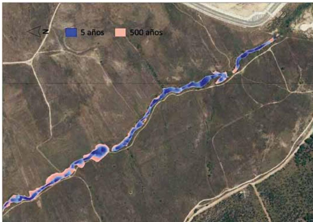
Fig 28. Detalle del tramo final del arroyo para la manchas de inundación en el estado actual para la MCO y el T500
