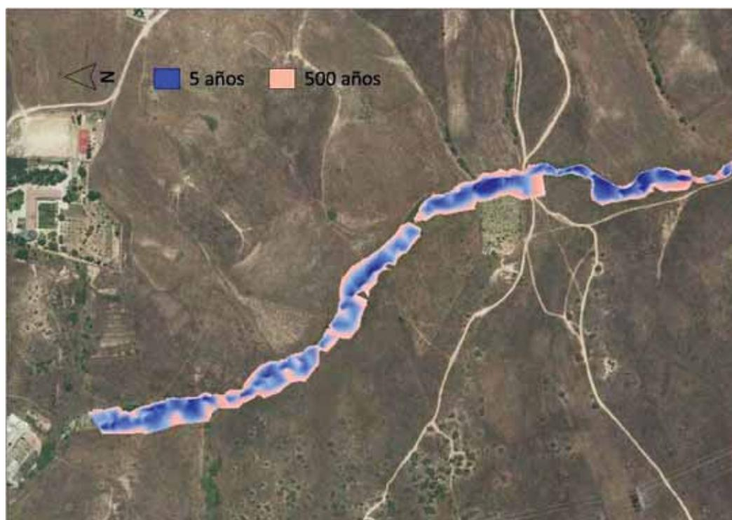
Fig 27. Detalle del tramo inicial del arroyo para la manchas de inundación en el estado actual para la MCO y el T500
