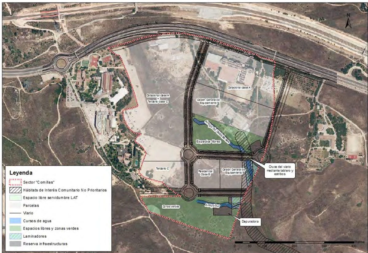
Figura 38. Cruce del viario propuesto en dirección este-oeste con el arroyo Valdelacasa. Fuente: elaboración propia.
