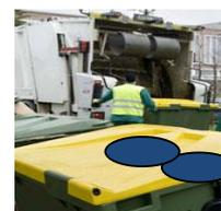
**Carga Lateral.** Sistema automático en el que al estar el contenedor en una posición fija no precisa de peón para la aproximación del contenedor al vehículo realizándose el vaciado desde la cabina del camión. Precisa de un servicio de repaso. Contenedores desde 1,8 a 3,2 m<sup>3</sup>. Dotación: 1 conductor, y 1 camión recolector compactador de 24 a 25 m<sup>3</sup>
